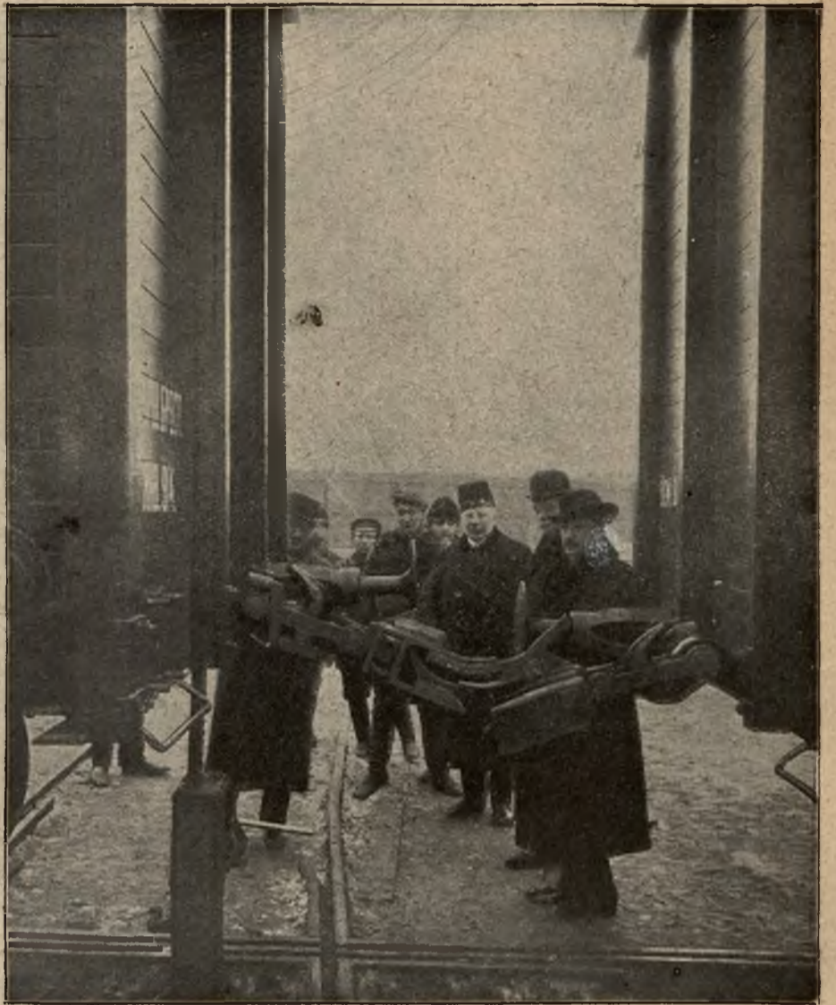
Łącznik w chwili automatycznego zaczepienia
