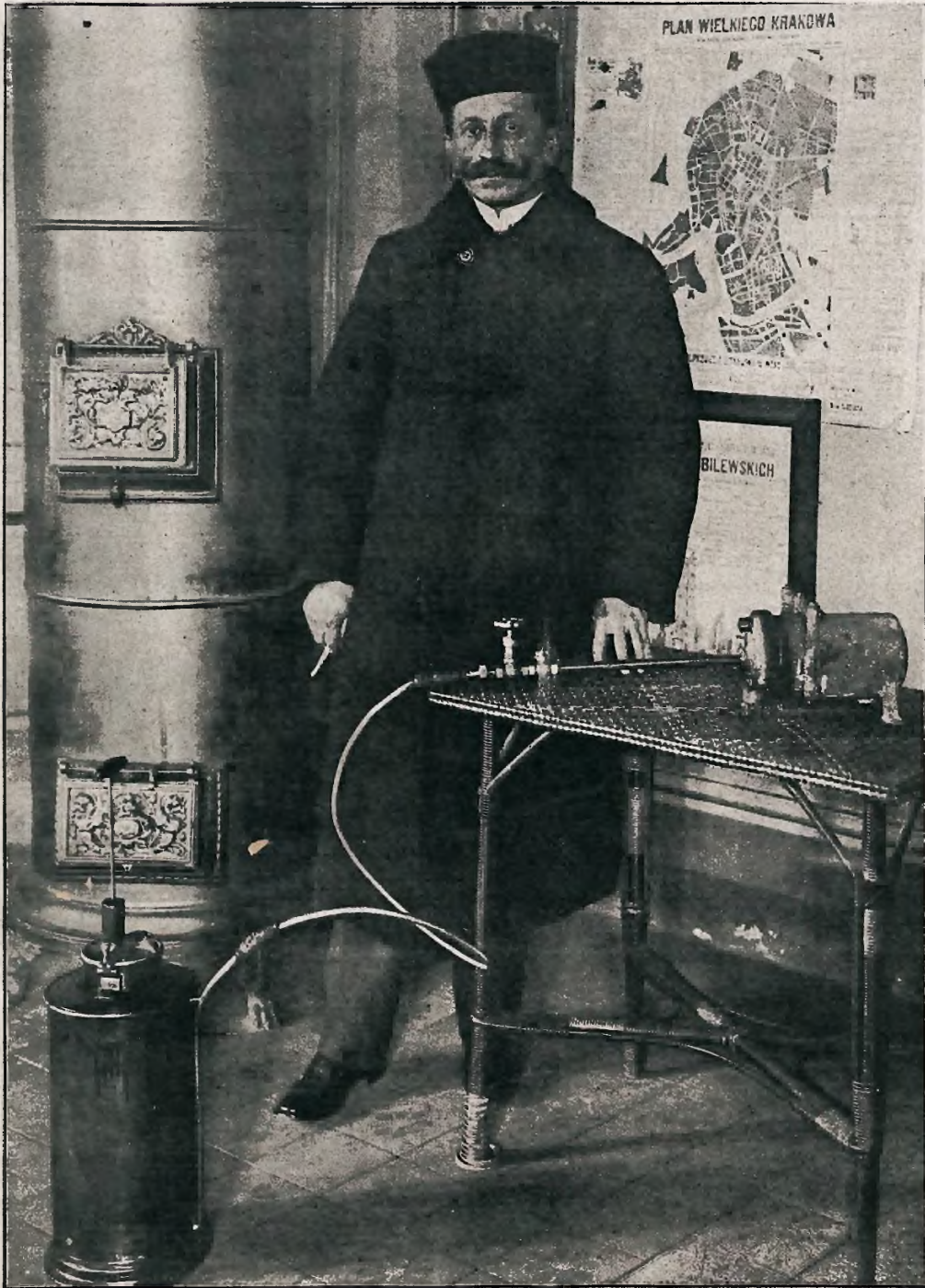
Próba wynalazku: Wynalazca Strzałkowski wraz z swoim przyrządem do opalania pieców ropą.
