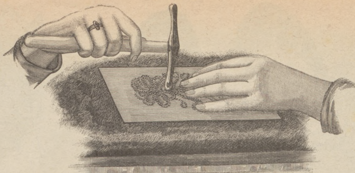
N. 12. Wytłaczanie na blasze mosiężnej do ryc. 13—15.
