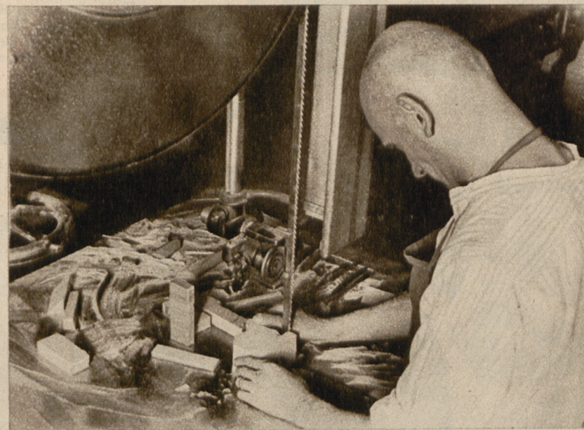
Die auf einem Holzblock aufgezeichnete Figur wird zunächst mit der Bandläge roh ausgefägt. In diesem Zustand erhält der Schnitzer das Holz zur weiteren künstlerischen Bearbeitung
