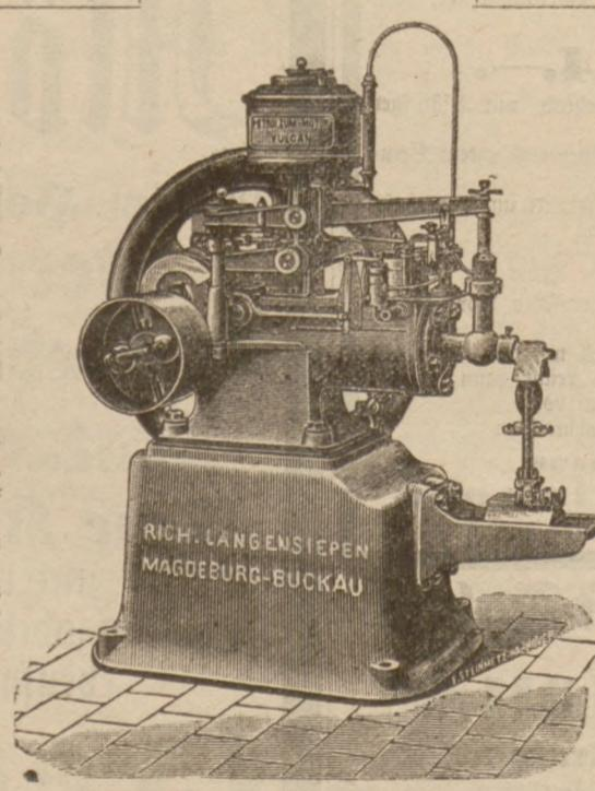
Bewährte billigste Betriebskraft für Kleinindustrie, landwirtschaftlichen Betrieb, für Wasserförderung, Krähe, Aufzüge, Schiffahrtszwecke etc., vorzüglich für **electrische Beleuchtung**. Durchaus aus gleichmässiger Gang und leichtem Anlassen, Sparsamer Betrieb, Petroleumbedarf pr. Pferdekraft u. Stunde ca. 0,5 kg. Spec. Gew. 0,825 kg = 1 Liter. Ausführliche Preislisten gratis und franco. Alle Größen bis acht Pferdestärken in flotter Fabrikation.
