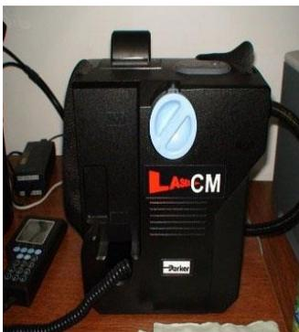
Fig. 17. Laser CM Analyzer Parker
