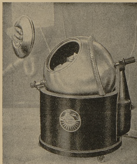
Rys. 10. Kocioł gazowy do prania o kształcie kulistym, wprowadzany w ruch wirowy.
